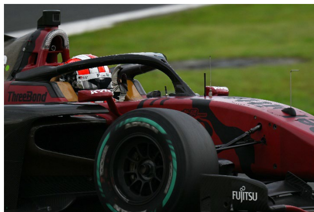
開発テスト車両 通称「赤寅」走行中の様子(運転席すぐ前にアンテナとカメラを設置)
