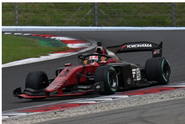
開発テスト車両 通称「赤寅」走行中の様子(運転席すぐ前にアンテナとカメラを設置)
