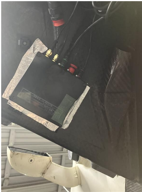
開発テスト車両 通称「白寅」に搭載されたローカル 5G のアンテナ(左)と伝送端末(右)
